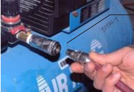
少し大きめのコンプレッサーのホース接続部分は通常こんなふうになっているのものが多く、カフソケットにカフプラグがワンタッチで抜き差しできるようになっています。サイズ的には 1/4 サイズが多いです。
