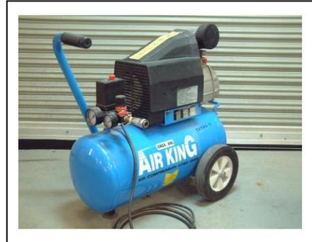
AIRBRUSH メーカーが出している AIR コンプレッサーは AIR タンクが付いていないものが多く、その場合、常時運転タイプがほとんどで常にブーンといった音がします。小さな小物に絵を描くだけなら十分なのですが、車のボンネットやトランク等に絵を描いて仕上げまでする場合、最後に必ずクリアーコートの工程があります。その時、大きめのスプレーガンでクリアーを吹くのですが、大きいスプレーガンになればなるほど、大量の AIR が必要となってきます。小さな AIR コンプレッサーでは空気が追いつきません。それなりの大きさの AIR コンプレッサーが必要となるわけです。
